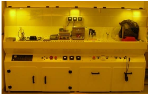
Hotte à flux laminaire équipée (classe 100) en salle inactinique (installation Megias)
