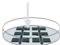
(a) Déversement du PDMS et du réticulant sur motifs en SU8
