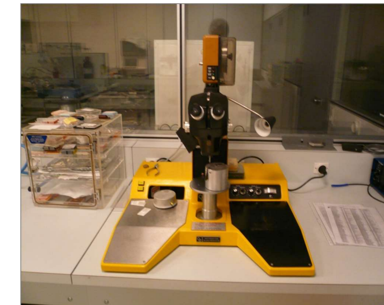
Câbleuse Orthodyne fils Al 100-300µm
